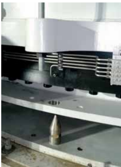
17 Centreerpen en geleidingsstoelen voor de exacte positionering
