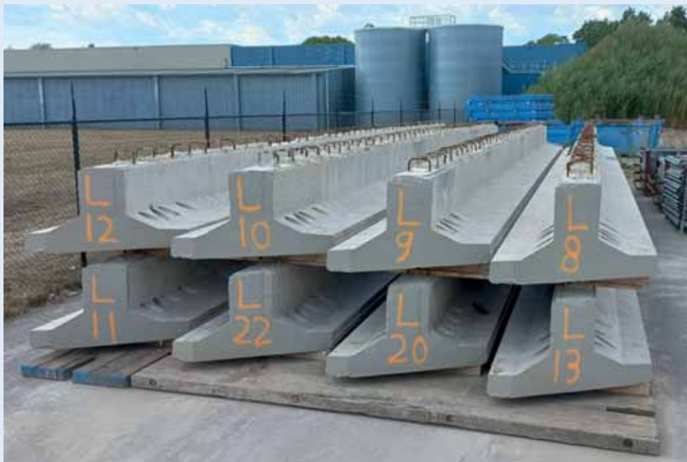
4 Liggers opgestapeld in de opslag na eindkeuring foto: Royal HaskoningDHV
