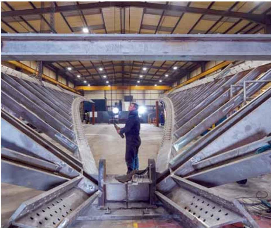
8 Fabricage van het roestvaststalen exoskelet door M-tec (architectendivisie WEC-Group) © WEC
