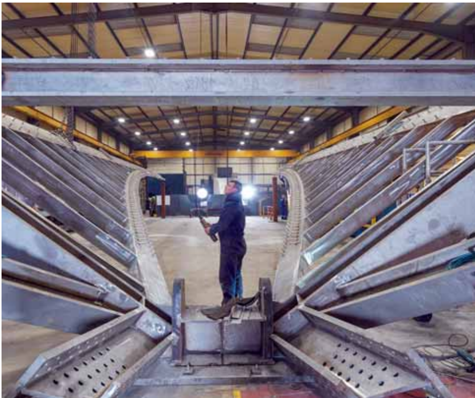
8 Fabricage van het roestvaststalen exoskelet door M-tec (architectendivisie WEC-Group) © WEC
