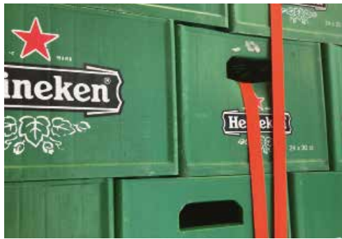
Vervorming door temperatuursverhoging
