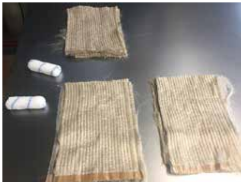
Wapening voor het biocomposiet
