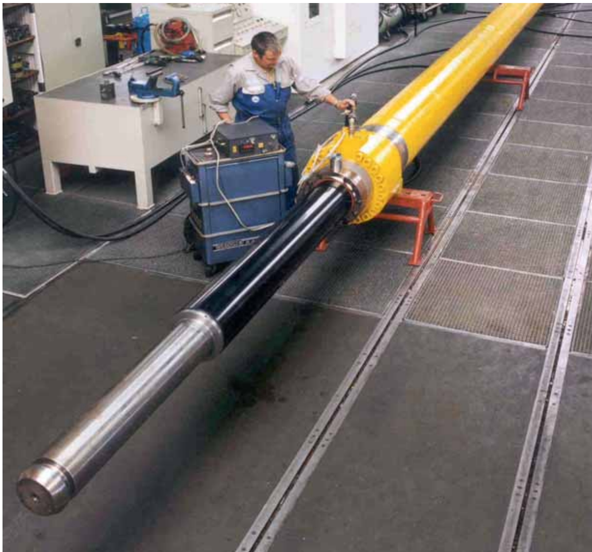
Zuigerstang met keramische Ceramaxcoating
