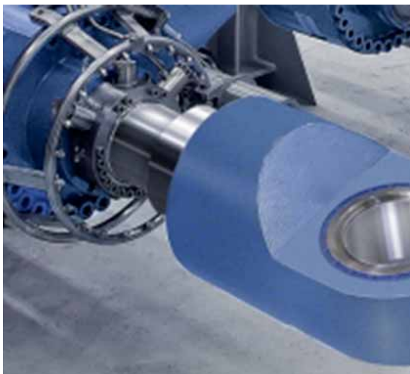
↓ Detail redundante meetsystemen op cilinders
