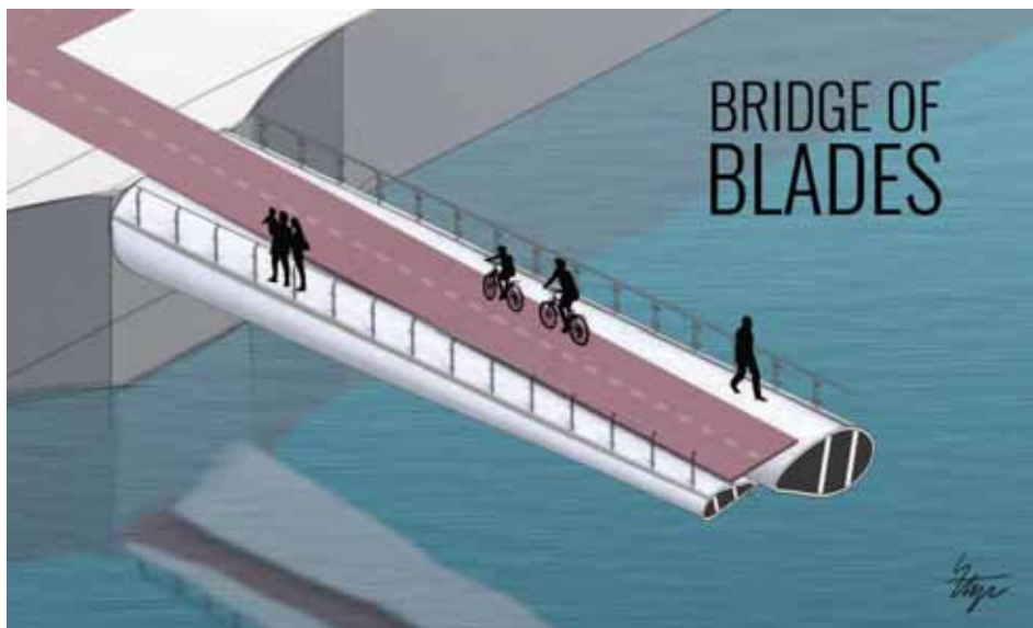
Brug van afgedankte windturbinebladen
