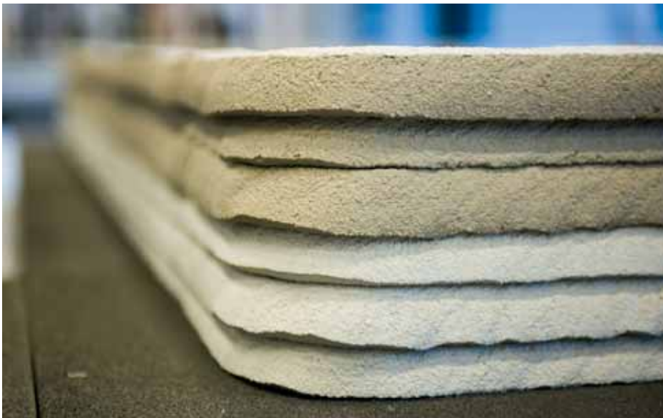
↑↓ 4-5 Het meng-pompsysteem is gekoppeld aan de besturing van de robot; de output van de printer wordt dynamisch geregeld, evenals het type materiaal dat wordt verpompt en geprint (foto's: Rien Meulman)
