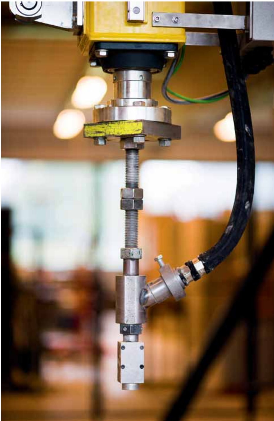
↑↓ 4-5 Het meng-pompsysteem is gekoppeld aan de besturing van de robot; de output van de printer wordt dynamisch geregeld, evenals het type materiaal dat wordt verpompt en geprint (foto's: Rien Meulman)
