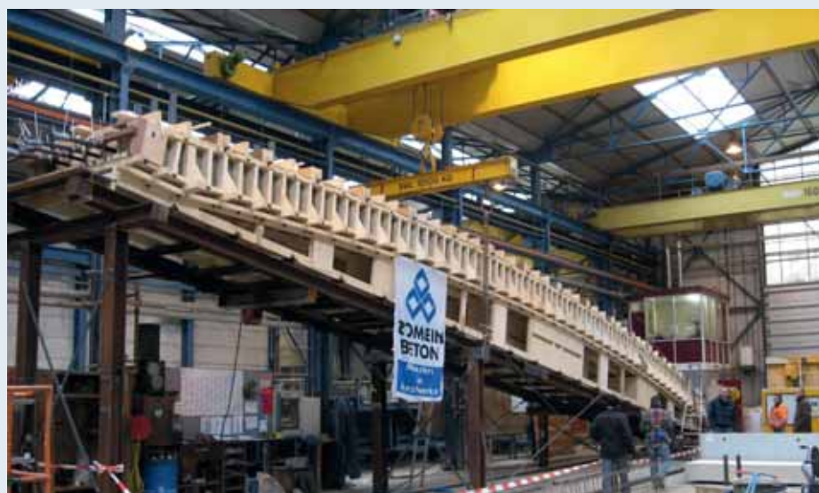
Schuin geheven mal tijdens het pompen van het Z-HSB van onderaf.
