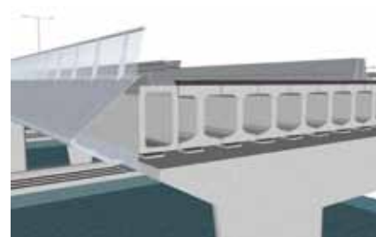
Afb.2. RHE-ligger toegepast in aanbruggen (© Romein Beton)
