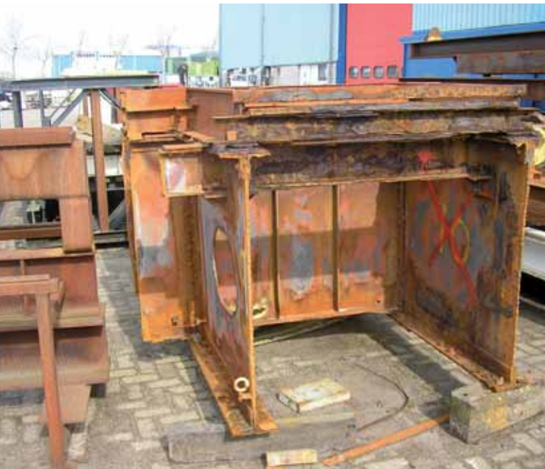
afb. 6 Door corrosie zwaar aangetaste middenligger (foto ing. J. Stout)
