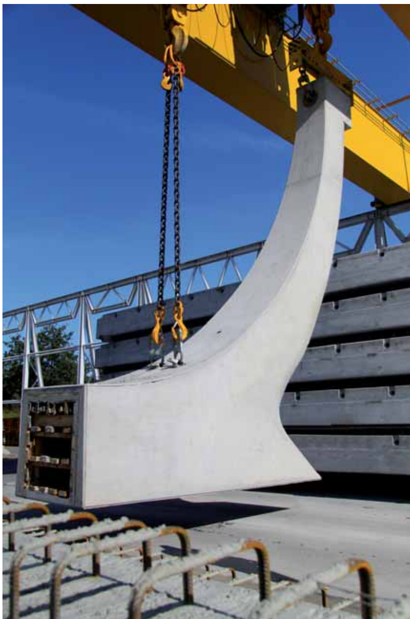
Een van de 60 ton zware pijlerelementen verlaat de fabriek van Haitsma Beton. (Foto: Haitsma Beton B.V.)
