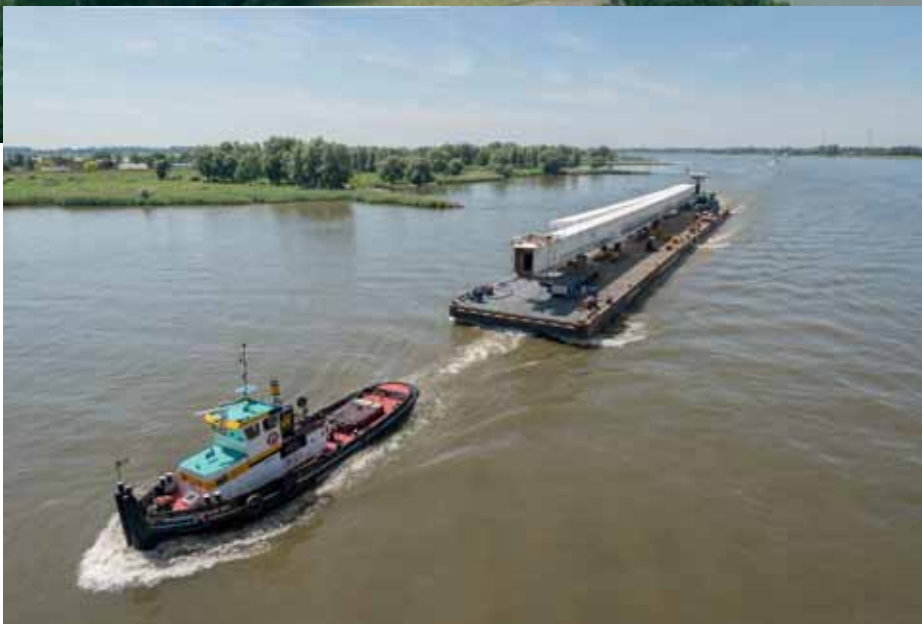
← ↑ De drie delen van één ligger zijn over water naar de bouwplaats vervoerd. © Rindert van den Toren
