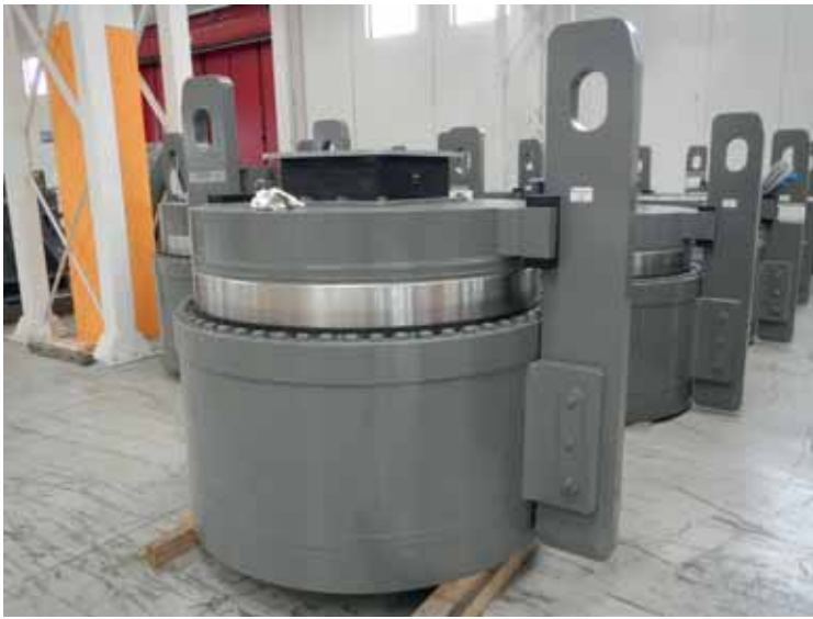
↑ 3 Belastingbegrenzers (Load Limiting Devices) voor rotwagens
