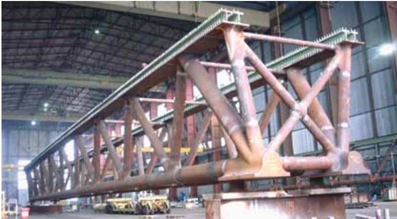
Figuur 7. Spoorbrug bij Oosterbeek, V-vormig vakwerkligger; buisprofielen met gegoten knooppunten; hooggelegen rijvloer uitgevoerd in beton
