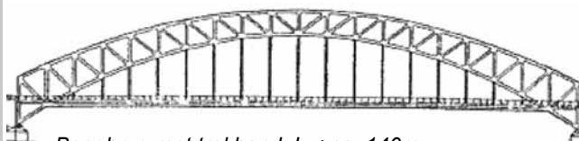
Boogbrug met trekband: L < \text{ca. } 140\text{m} .
