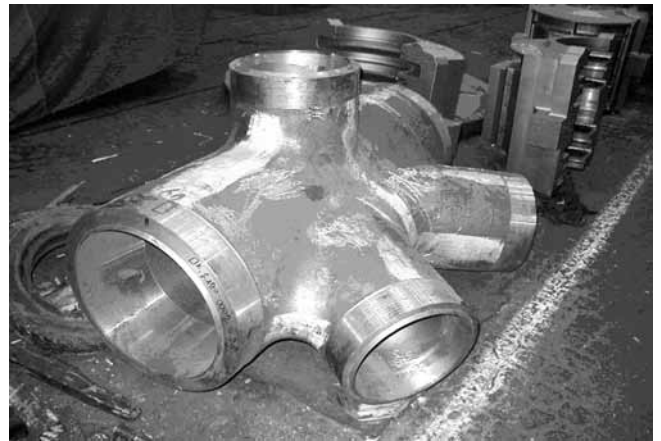
Figuur 7. Spoorbrug bij Oosterbeek, V-vormig vakwerkligger; buisprofielen met gegoten knooppunten; hooggelegen rijvloer uitgevoerd in beton
