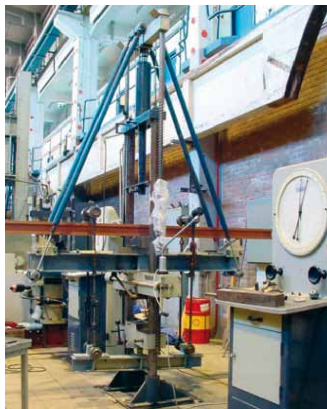
5-puntsbuigproef houten liggers (zie blz. 24)
